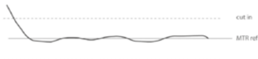
Figura 6.- Muestra del control de la temperatura con tecnología de modulación de pulsos
